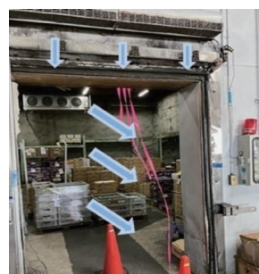
写真1 冷蔵庫扉周辺の空気流れ
